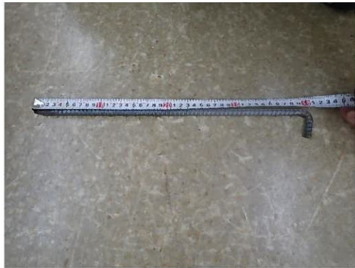
L型アンカー（異形鉄筋D10×400）
