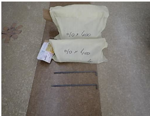
L型アンカー（異形鉄筋D10×400）
